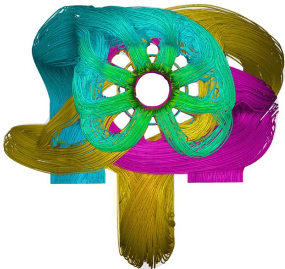
L'image ci-dessous montre les lignes de courant d'un fluide dans un modèle statique de dynamique des fluides numérique d'un corps de vanne. Crédit : Domin.
