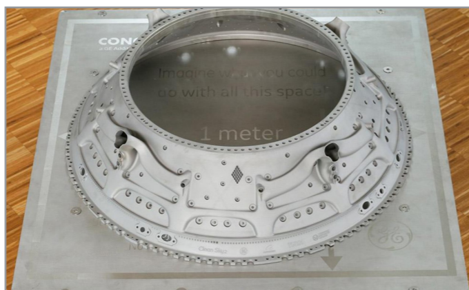
Légende : Pour ce projet MOnACO - une expérience d'aviation propre - le nombre de pièces dans un assemblage a été réduit de plus de 100 à une seule pièce. (La conception générative Fusion 360 a été utilisée pour optimiser la conception de la structure et de l'écoulement des fluides dans le cadre de ce projet).
