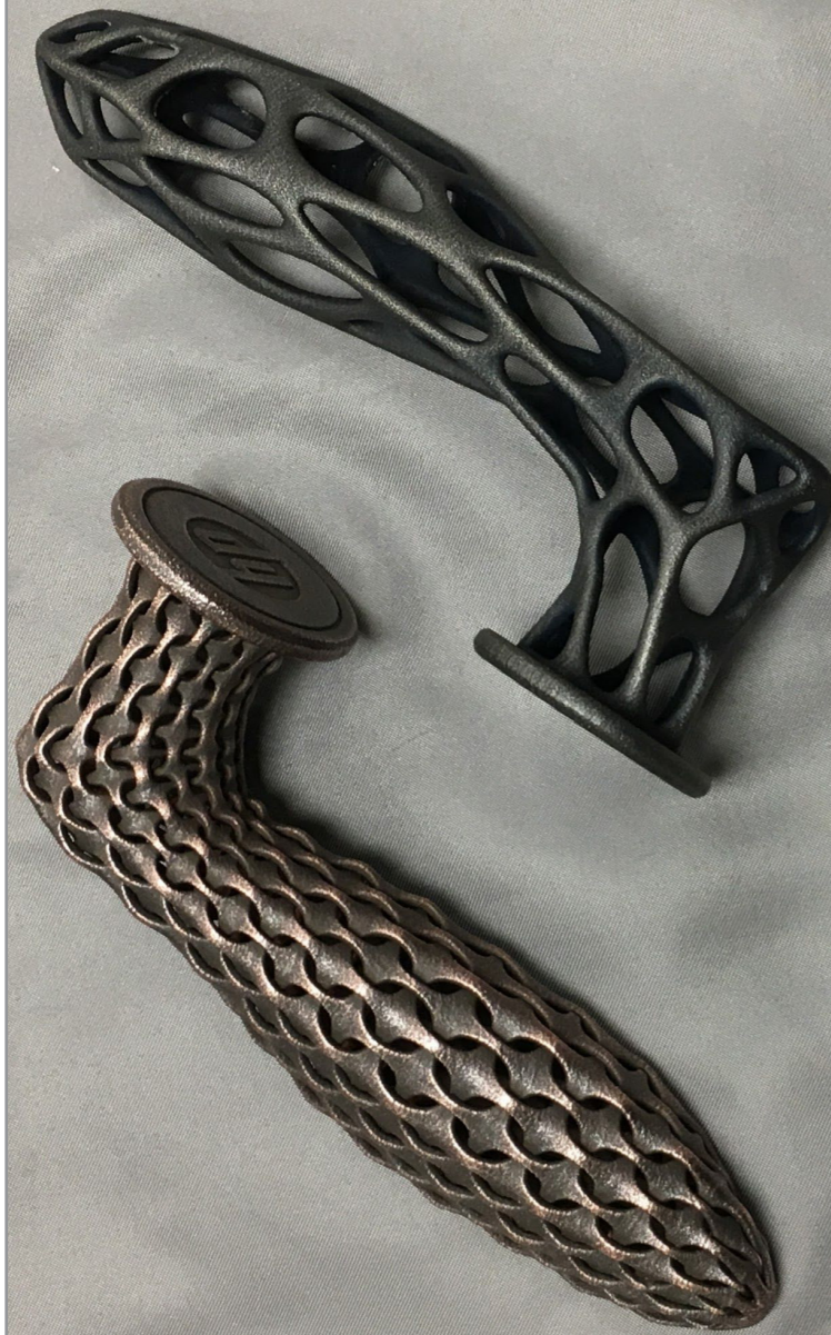
Comparaison de la résistance SAMPE du treillis à topologie optimisée à partir de résine SLA imprimée, de résine électrodéposée et d'une technologie basée sur l'IA – Crédit : avec l'aimable autorisation de RePliForm Inc.
