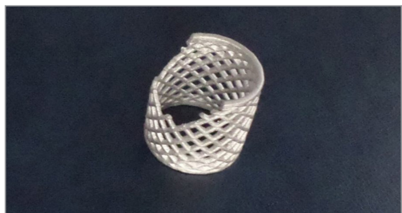
Pièce frittée, cassée pendant l'enlèvement de poudre en raison de la faible résistance de la pièce verte. Image via Fraunhofer IFAM.
