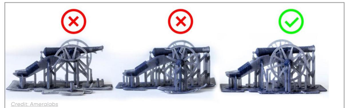
Cette étape peut être réalisée avant ou après le durcissement. En général, il est recommandé de retirer les structures avant le durcissement car le processus est plus facile. Les opérateurs qui les enlèvent après le durcissement prennent le risque d'endommager la pièce ou d'enlever de petits morceaux de matériau.
