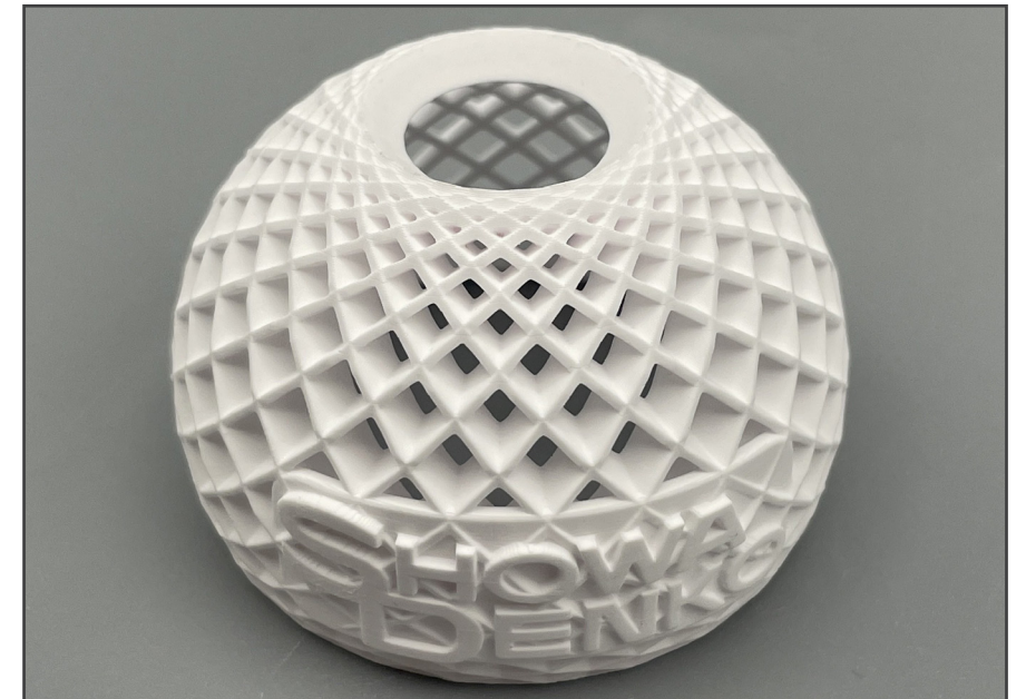
Légende : Impression 3D en alumine de haute pureté à base d'une résine UV développée par Tethon 3D et Showa Denko America. Cette alumine de haute pureté est 25 % plus forte que celles des concurrents. La charge céramique est supérieure à 75 % en volume et à 90 % en poids. En raison de cette charge plus élevée, le retrait dans les directions x, y et z est inférieur à 10 % après le frittage. Crédit : Tethon3D
