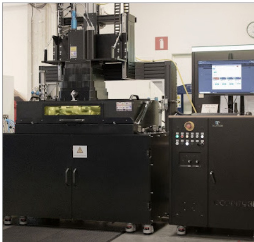
Légende : l'image montre une machine Aerosint à côté d'un système Aconity3D. Aconity MIDI+ : Aujourd'hui, l'approche de l'impression multi-matériaux a été validée dans le cadre d'un processus de fusion laser à lit de poudre. L'imprimante Aconity MIDI+, équipée du dispositif de reprise d'Aerosint, est la première imprimante multi-matériaux par fusion laser à lit de poudre disponible dans le commerce. Image: Aerosint.
