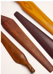
Le procédé Forust combine deux flux de déchets de la production traditionnelle du bois, la sciure et la lignine, pour produire des pièces de bois isotropes et à haute résistance - Image via Desktop Metall
