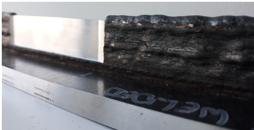
Légende : état de surface entre l'impression WAAM et l'usinage CNC. Crédit : l'Institut belge de soudure.
