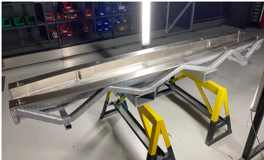
Légende : Moule de stratification pour la fabrication de pièces composites aérospatiales ; matériau : Invar ; environ 200 kg et plus de 3 m de long – Crédit : Lincoln Electric
