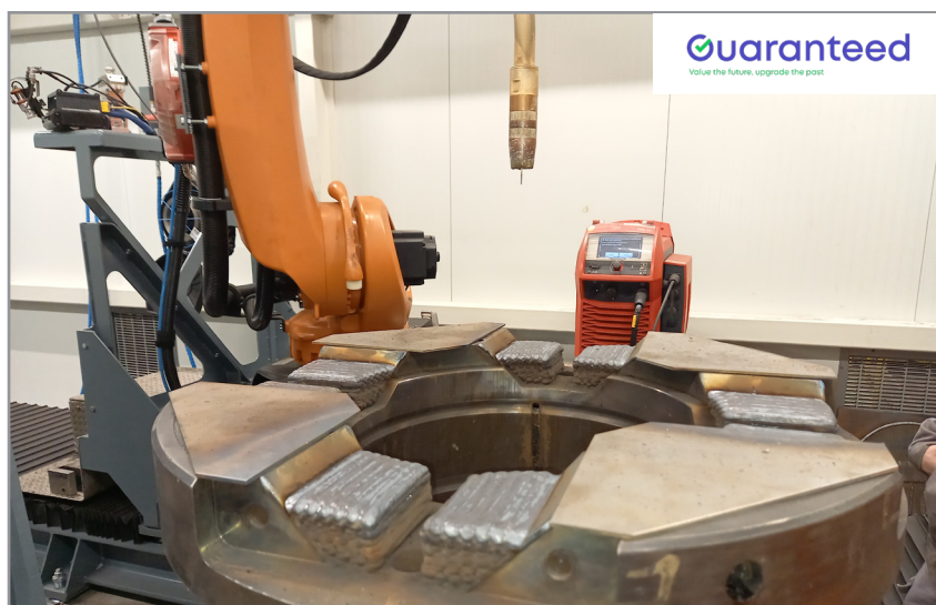
Légende : Réparation de la douille du mandrin. Crédit : Guaranteed.
