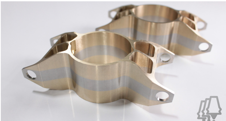
Image : Hybrid Manufacturing Technologies. Légende : Supports multi-métaux bénéficiant de de la dissipation thermique et du pouvoir lubrifiant du bronze avec la résistance de l'acier inoxydable, imprimés et finis dans une CNC hybride équipée du système AMBIT™ FLEX.
