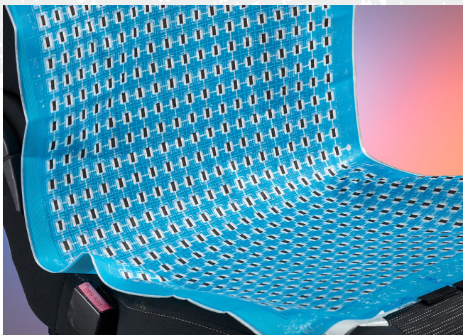
Image : Holst Centre – En collaboration avec l'industrie automobile, Holst Centre développe des solutions de détection sans contact basées sur les technologies de l'électronique imprimée.
