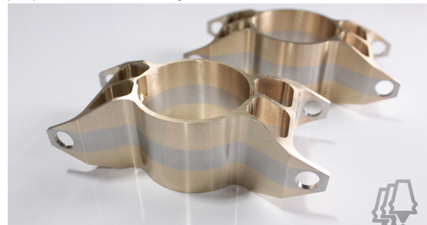
Image : Hybrid Manufacturing Technologies. Légende : Supports multi-métaux bénéficiant de de la dissipation thermique et du pouvoir lubrifiant du bronze avec la résistance de l'acier inoxydable, imprimés et finis dans une CNC hybride équipée du système AMBIT™ FLEX.
