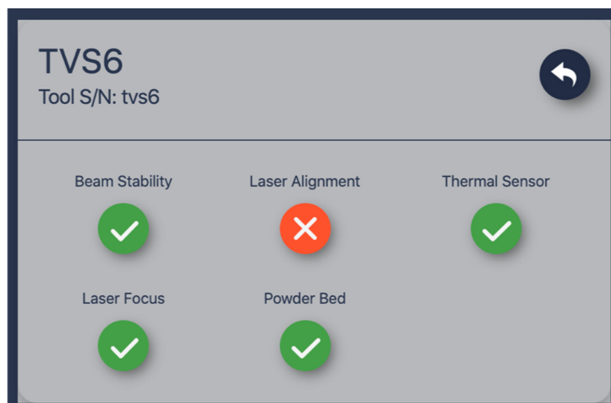
Image 2. La santé de la machine dans un système VELO3D Sapphire peut être vérifiée par un simple clic pour s'assurer que la qualité du lit de poudre, les capteurs et l'optique sont calibrés et en condition optimale, et ne compromettent pas la qualité des pièces. Image reproduite avec l'autorisation de VELO3D.
