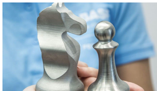
Crédit : Forward AM par BASF - Pièce produite avec un filament métallique sur la technologie FFF
