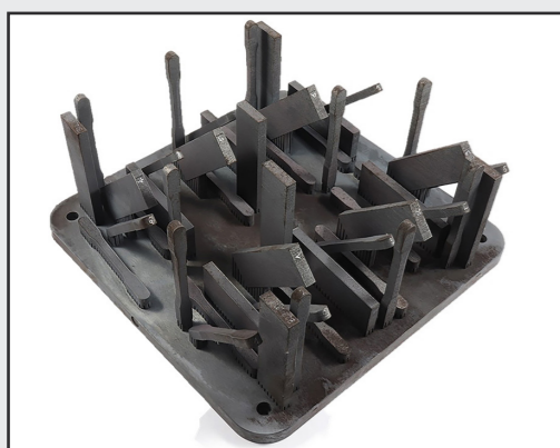
Légende : Traitement thermique de 20MnCr5 sur la plate-forme de construction © GKN Powder Metallurgy
