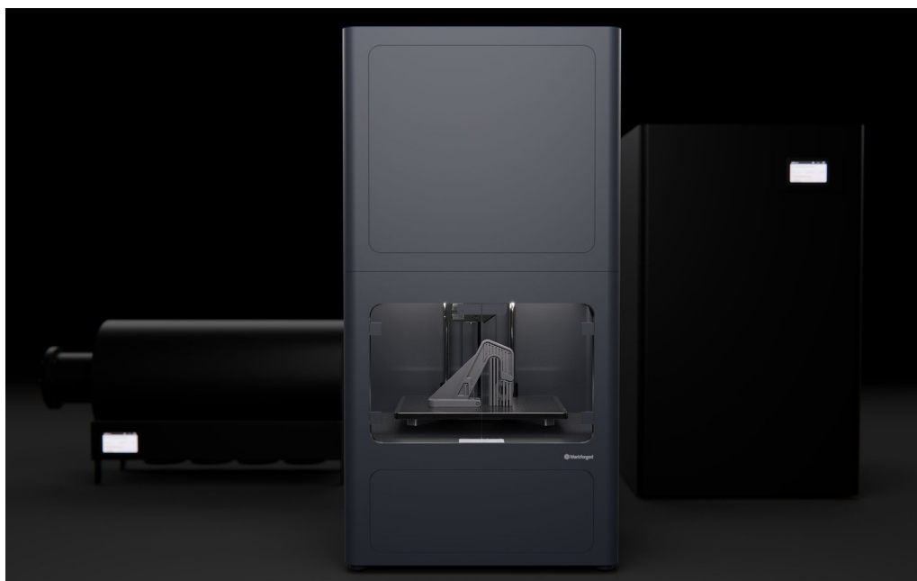
Metal X de Markforged - Imprime de la poudre de métal liée dans une matrice en plastique tout en permettant des fonctionnalités telles que le remplissage à cellules fermées pour un poids et un coût réduits.
