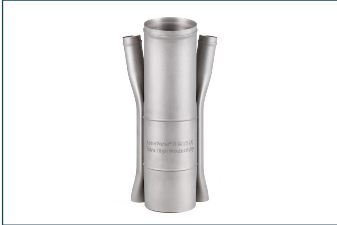
Pièce en métal de voiture fabriquée à partir de l'imprimante 3D métal de 3D Systems ProX DMP 320
