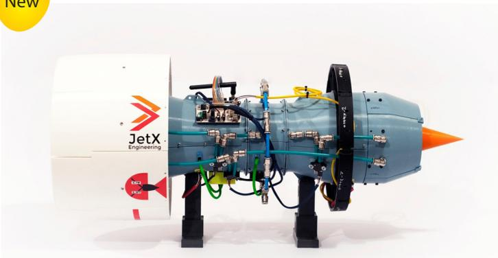
X-plorer, le réacteur avec plus de 515 pièces imprimées en 3D
