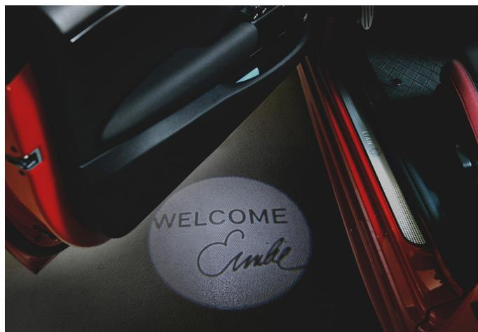
Les projecteurs de porte créent un éclairage qui peut être conçu individuellement. L'éclairage est projeté sur le sol par une source de lumière LED lorsque les portes du conducteur et du passager sont ouvertes. Le diamètre de la projection est compris entre 40 et 50 centimètres.
